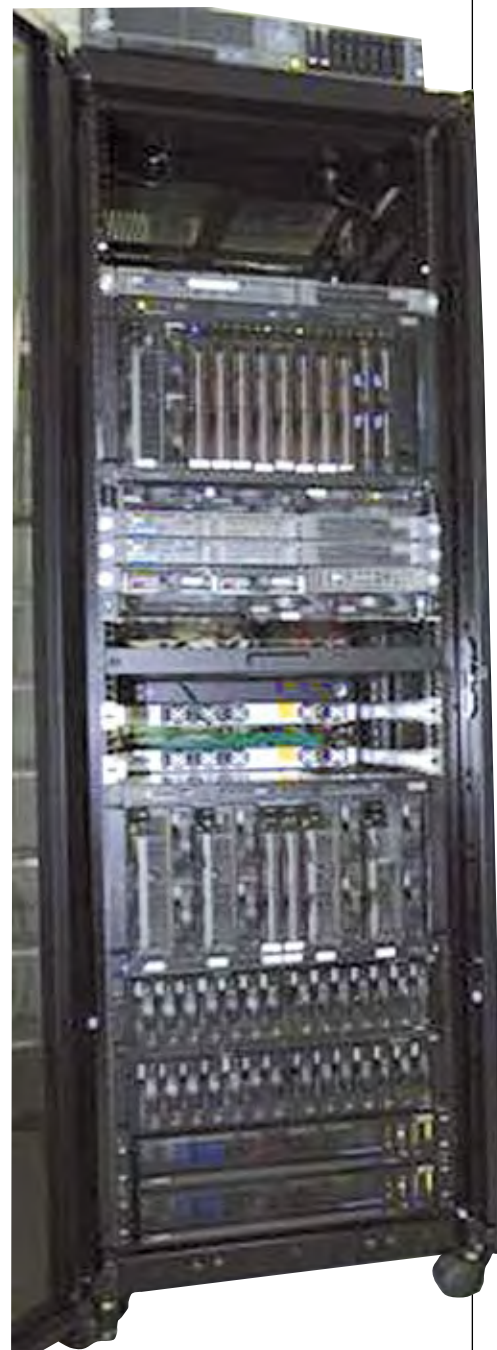
ЦОД для СВГК базируется на двух серверах IBM BladeCenter с установленными серверами баз данных
